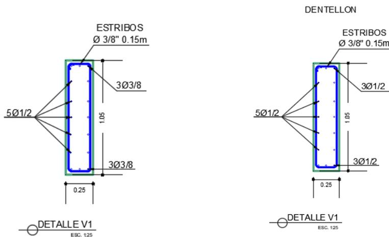
**Resolución Única: Utilizar el armado de la viga de 3Ø1/2”.**
